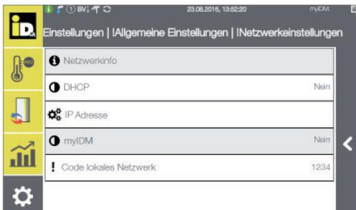
Für die Modbus TCP Kommunikation wird deshalb die Einstellung einer statischen IP-Adresse empfohlen.
