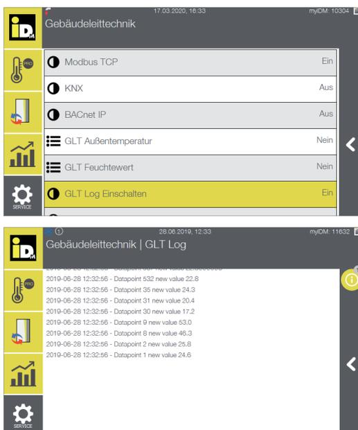
Zur Überprüfung der Kommunikation den Parameter „GLT Log Einschalten“ aktivieren. Dieser Parameter wird nach einer Stunde wieder automatisch zurückgesetzt.
