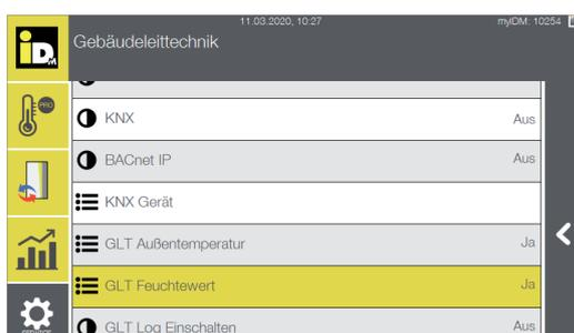
Für die Kommunikation des Feuchtwertes ist der Parameter „GLT Feuchtwert“ auf „Ja“ zu stellen.
