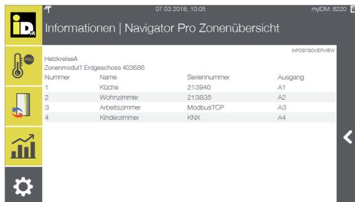
Bei Räumen mit Modbus TCP-Raumsensor wird bei der Seriennummer „Modbus TCP“ angezeigt. Die aktuelle Raumtemperatur muss über die jeweilige Adresse kommuniziert werden, z.B. für Raum 3 wäre das die Adresse 2016.
