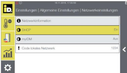
Mit Umstellung des Parameters „DHCP“ auf „Ein“ erhält die Wärmepumpe automatisch die Netzwerkeinstellungen.
